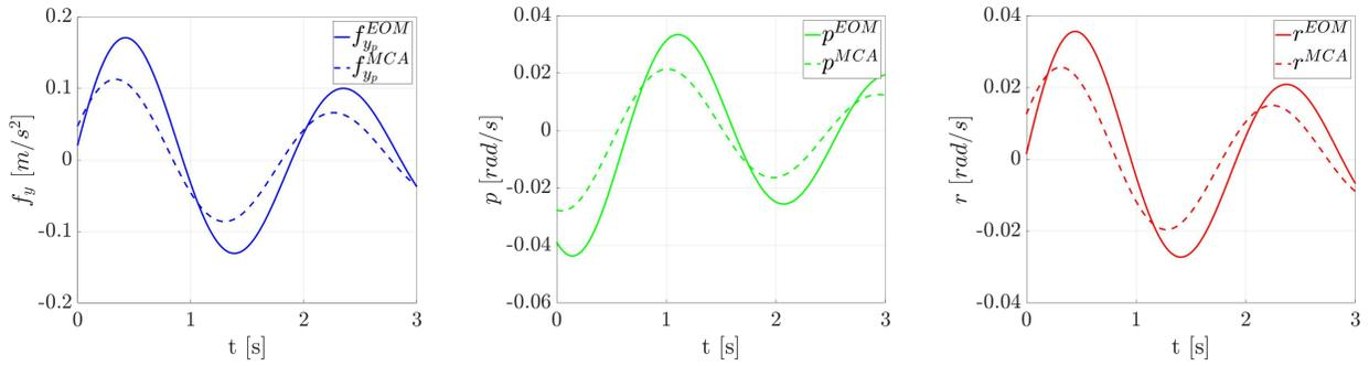
**Fig. 4 Time Histories of Dutch Roll Eigenmode Excitation**
