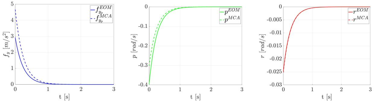
**Fig. 5 Time Histories of Aperiodic Roll Eigenmode Excitation**
