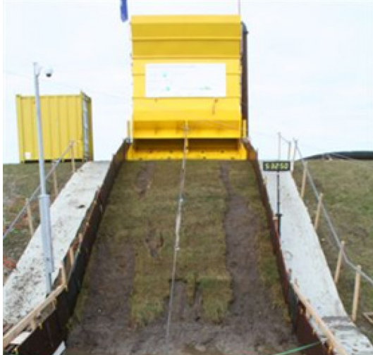
Figuur 3.3 Vroegtijdig afstroepen van de graszode (bovenste deel toplaag), maar het resterende deel van de toplaag bleek zeer erosiebestendig. Foto genomen tijdens golfoverslagproeven op de Afsluitdijk (bron: Rijkswaterstaat, 2012).
