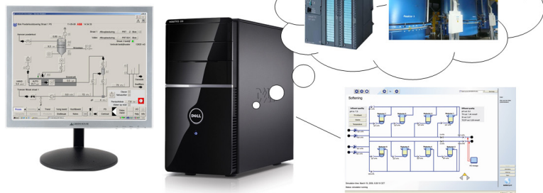
Figuur 5 - Door een procesmodel te koppelen wordt een nog meer waarheidsgetrouwe simulator gerealiseerd.
