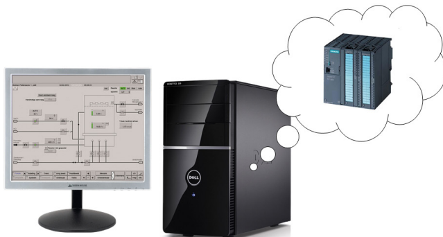
Figuur 4 - Emulatie van procesautomatisering software. Een PC gaat zich gedragen als één of meerdere virtuele procescontrollers (PLC's).
