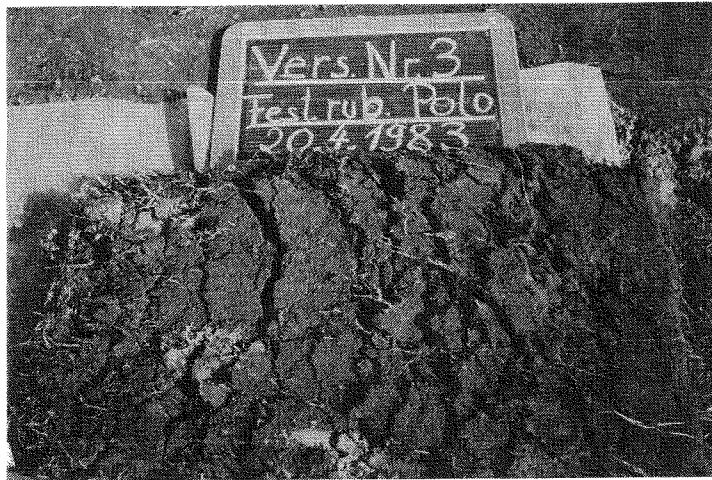
Foto 9: Scherfläche einer abgescherten Rasensode mit herausgezogenen Wurzeln (Sodenstärke 3cm bis 4cm).
