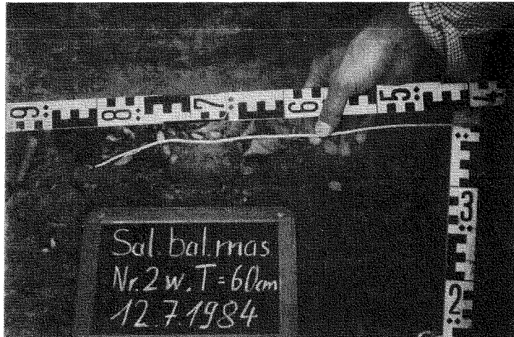
Foto 21: Der Zentralzylinder dieser Wurzel war etwa 44cm unterhalb der Scherfläche gerissen, während die Rinde in der Scherebene gerissen war.
