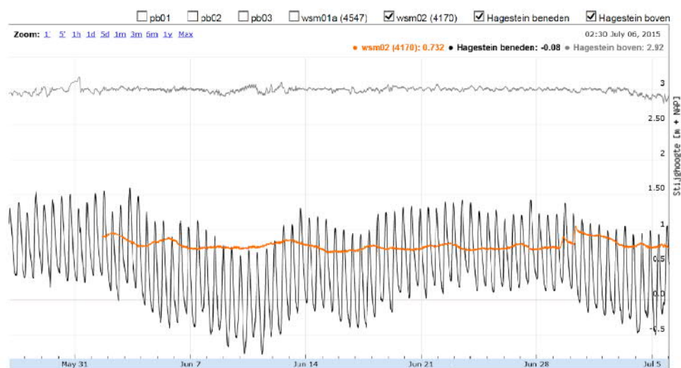
Figuur 9: Meetresultaten van waterspanningsmeter WSM02ten opzichte van het rivierpeil in de lek.
