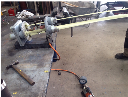
Figuur 24: Vijzel tbv afspannen nagelelementen
