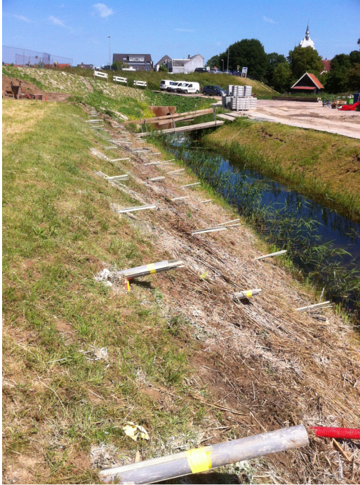
Figuur 22: Voorziening tbv uitbuigen glasvezelstrips
