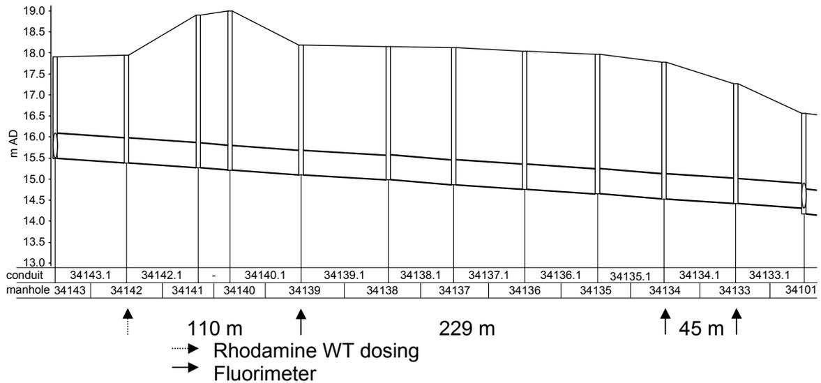
**Figure 4.22** Tracer experiment Beekbergen, reach 'Nieuwe Voorweg',  $\varnothing$  0.6 m.
