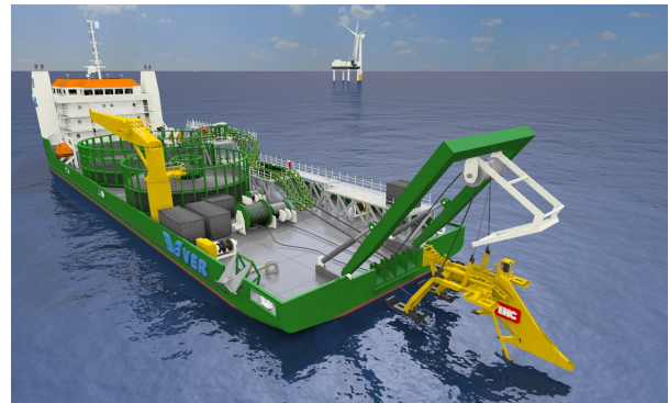
(d) Inter array cable vessel 10
