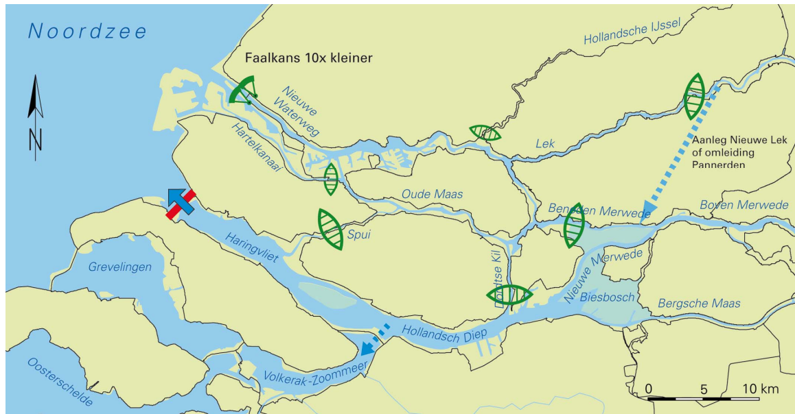
Figuur 4-1: Weergave van het alternatief Afsluitbaar zee- en rivierzijde – variant Nieuwe Lek (bron: Slootjes et. al, 2011).
