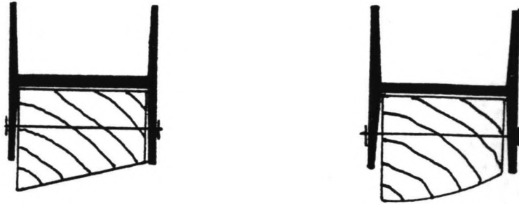
Figuur 39: Aanpassing onderkant schuif
