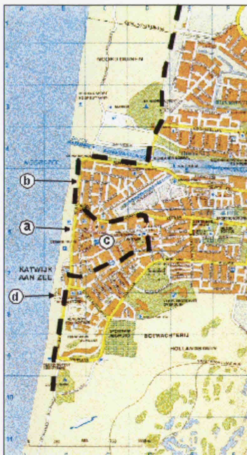
Figuur 1: Plattegrond van Katwijk. De toename van het bebouwde oppervlakte is aangegeven. Ook de ligging van de primaire waterkering is aangegeven, deze loopt deels door het oude centrum. Grote delen van het dorp liggen buitendijks.
