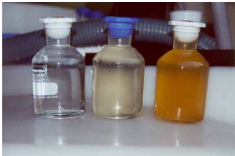
Figuur 3-9 Drie monsters genomen aan het einde van RUN 13. V.l.n.r: permeaat, voedingswater en spoelwater.
