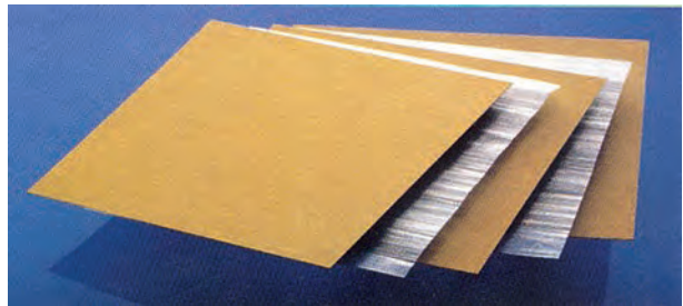
GLARE, een hybride composiet gebouwd uit dunne metaallagen (groen) en dunne composietlagen (glasvezelcomposiet – let op vezelrichting).
