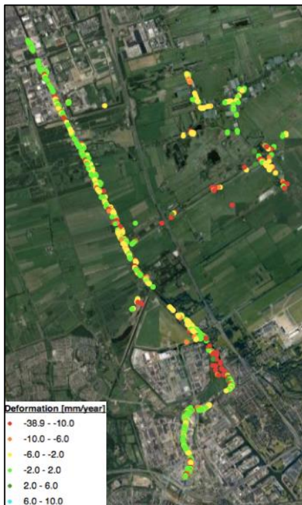
Fig. 2 Deformation velocity maps of the regional canal levees South of Delft, the Netherlands. / Cartes de vitesse de déformation de digues régionaux a Delft Sud, Pays Bas.
