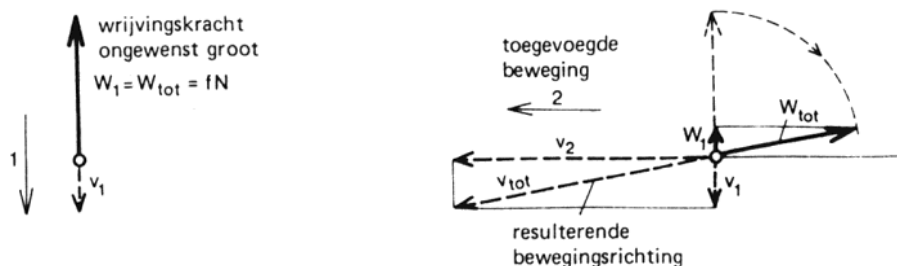
Figuur 4.6 Effect van het toevoegen van een extra beweging op de richting van de wrijvingskracht W_{\text{tot}} .
