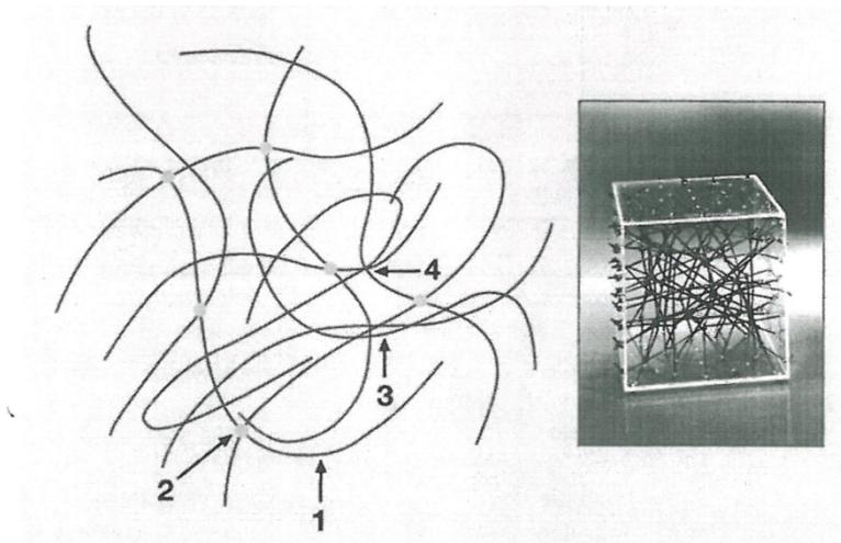
Abbildung 2-1: Bindungskräfte innerhalb eines Polymers [2.6]
