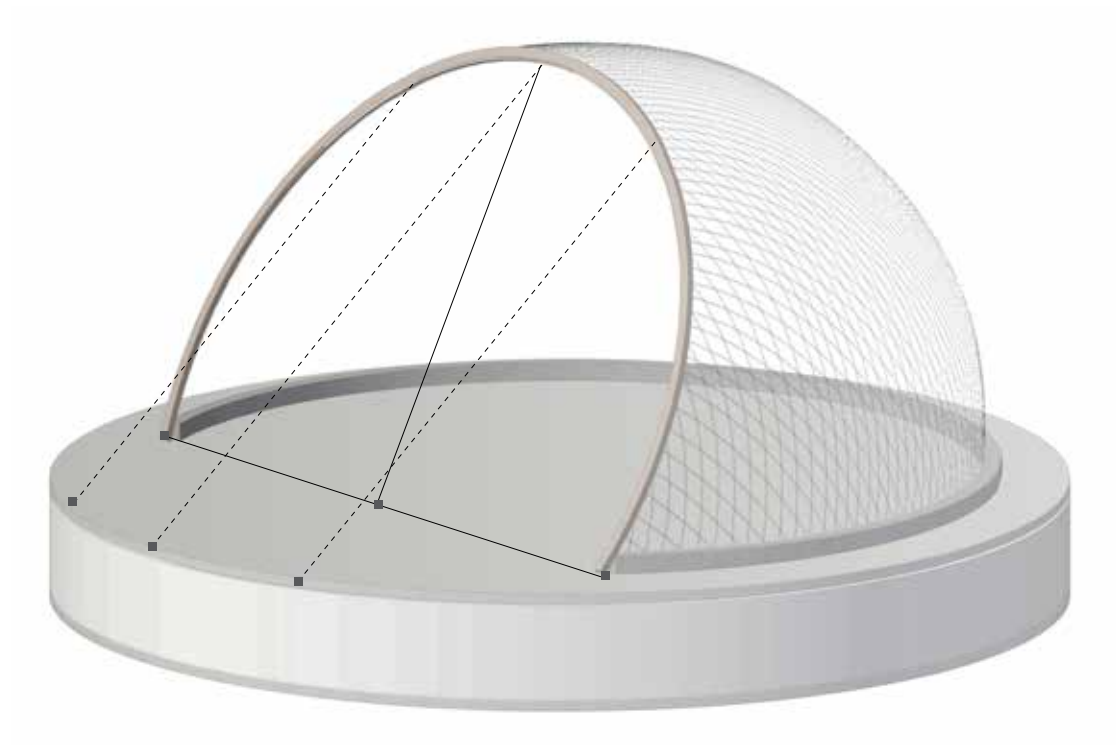
7. Gridshell gelamineerde latten in andere richting
