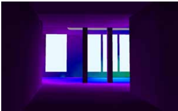
Figuur 10.6. Luminantie render vanuit de keuken naar de woonkamer van de ronde woonkamer
