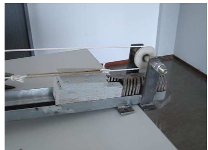
Figuur 3 - Uiteinde van geautomatiseerde goot
