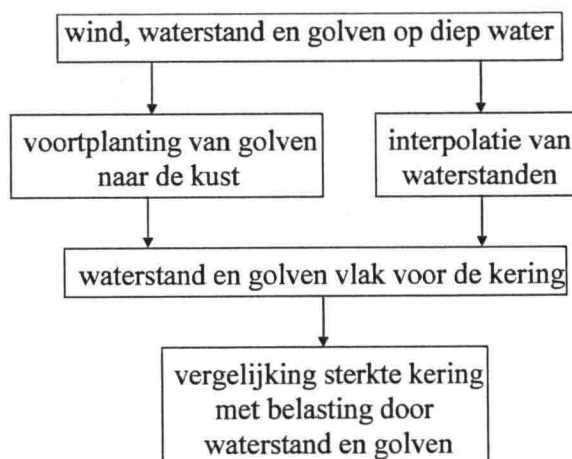
Figuur 2.1 Schematische weergave van de opzet van het belastingmodel. De bodem is een belangrijk onderdeel van het model waarmee de golfvoortplanting naar de kust wordt berekend (blokje 'voortplanting van golven naar de kust').
