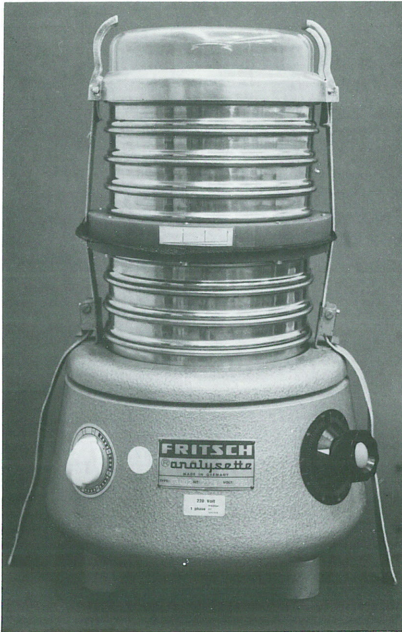
Foto 2. Zeefanalyse-apparaat voor de bepaling van de openingskarakteristieken van kunststoffilters
