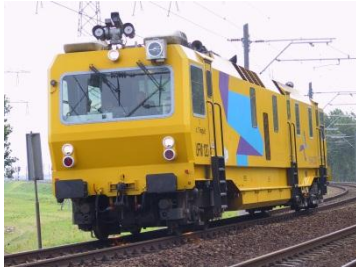
Universele meettrein UFM120 (o.a. geometrie, bovenleiding)
