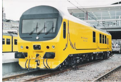
Ultrasoon inspectietrein UST96 (o.a. interne spoorstaafdefecten)
