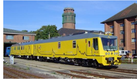
Ultrasoon inspectietrein UST02 (o.a. interne spoorstaafdefecten)
