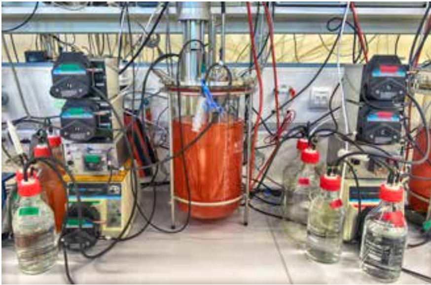
Onderzoekopstelling van de Radboud Universiteit Nijmegen (groep Mike Jetten) voor het zuiveren van afvalwater. Het reactorvat in het midden bevat de rode anammoxbacteriën die het (synthetische) afvalwater met ammonium zuiveren.
