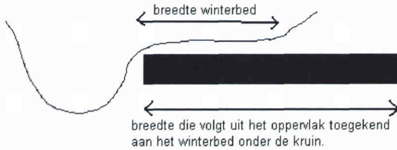
Figuur 6.2 Situaties waarbij een te groot bergend oppervlak achter de zomerdijk is toegekend
