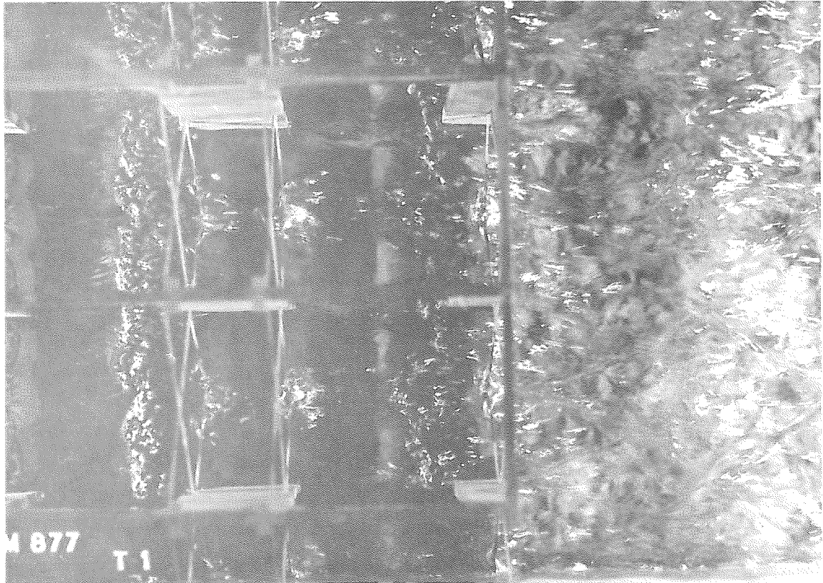
4. STROOMBEELD IN EN VLAK ACHTER DE CAISSON BENEDENWATERSTAND N.A.P. -2,50m
