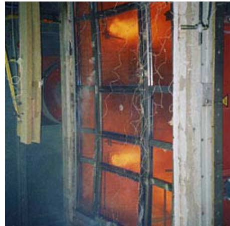
FIGUUR 5: VERVORMING BIJ BRAND
