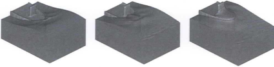
Figuur 5.8: Een simulatie met groen water op het dek van een FPSO; de golven en de beweging van de FPSO zijn geïnitieerd door een externe code
