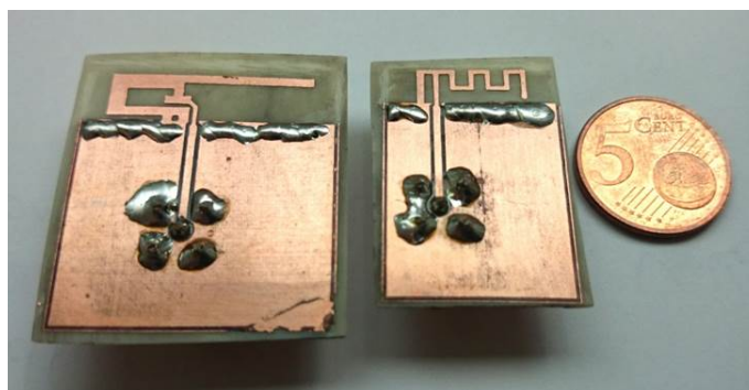
Figuur 5.1: Testbordjes voor de impedantiemetingen en stralingspatroon bepaling. Links de IFA, rechts de MIFA
