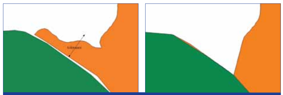
Fig. 4 Er bestaat geen optimale waarde voor een snapafstand die op een gehele dataset kan worden toegepast. In dit geval wordt een deel van de polygon onterecht tot een lijn geconverteerd vanwege een te grote tolerantiewaarde.
