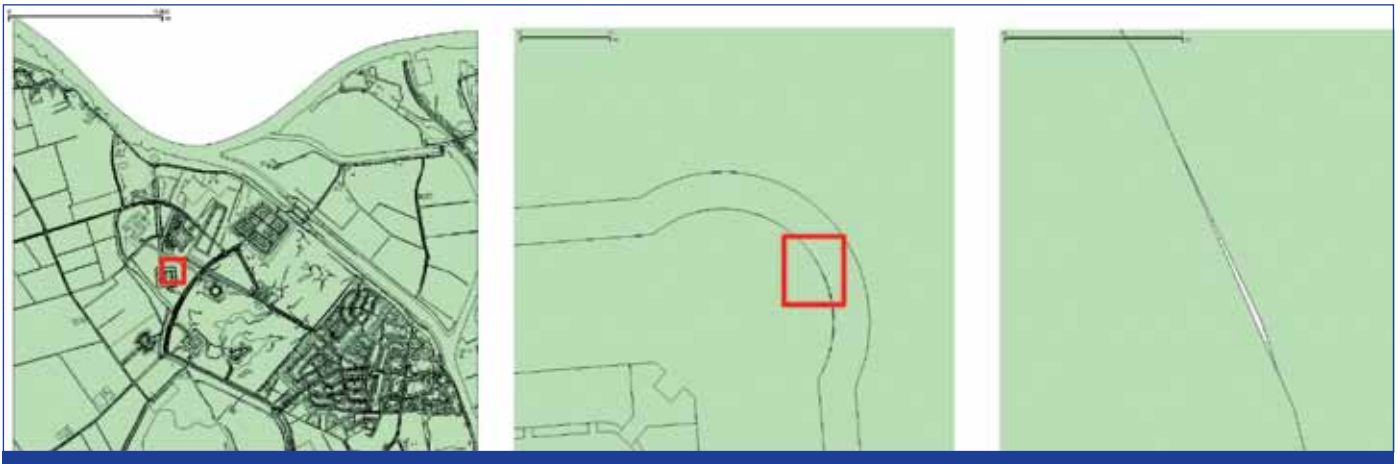
Fig. 3 Het vertalen van cirkelbogen naar expliciete coördinaten ('stroken') kan leiden tot een opeenhoping van 'slivers', omdat de cirkelbogen in twee verschillende richtingen – eenmaal voor het rechtervlak, eenmaal voor het linkervlak – worden behandeld.
