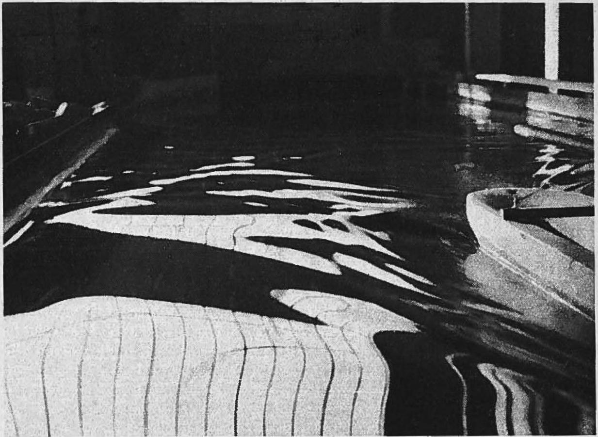
*Fig. 8. — Onde d'arcasse d'un modèle de bateau (cas limite.)*
