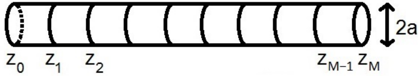
Figuur 2: Een stroomdraad met dikte 2a opgedeeld in M stukken.
