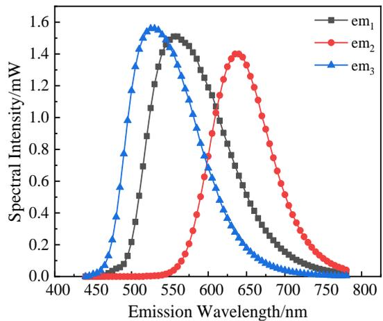
图 3 3 种荧光粉的发射光谱
