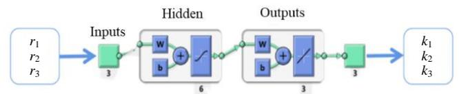
图 5 混合荧光粉发射光谱比例系数预测网络结构图
