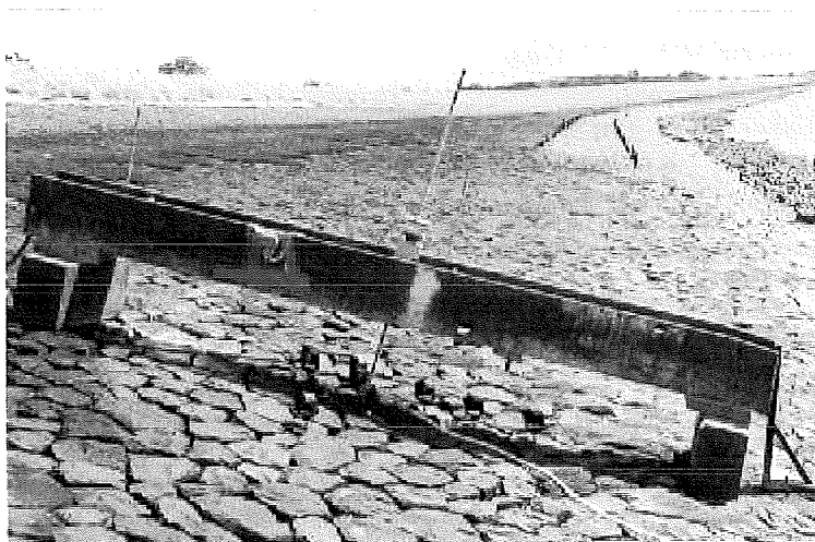
Figuur 4.4 Uitvoering trekproef
