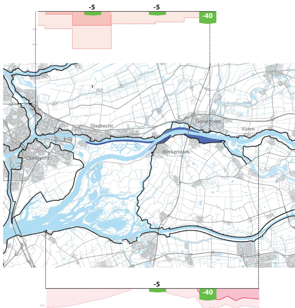
Figuur 28 Maatregelpakketen extra ruimte voor de rivier A1 (links) en A2 (rechts) (afbeelding: Provincie Gelderland & Defacto 2013)
