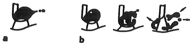
Figuur 29: a)fijne spatten vanaf electrodedruppels en b)het uiteenvallen van druppels.[6]
