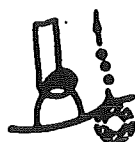
Figuur 30: Fijne spatten vanuit het smeltbad.[6]
