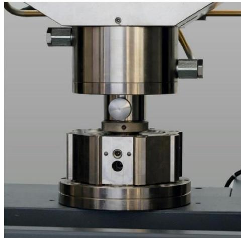
Ausrichteinheit mit Bolzenverbindung direkt auf die Traverse montiert
