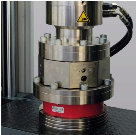
Ausrichteinheit in Flanschverbindung montiert zwischen Kraftaufnehmer und Probenhalter
