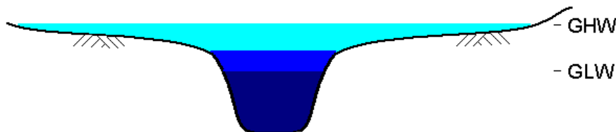
Figuur 14.1: Dwarsprofiel kreek met flauwe taluds ter hoogte van de waterlijn.
