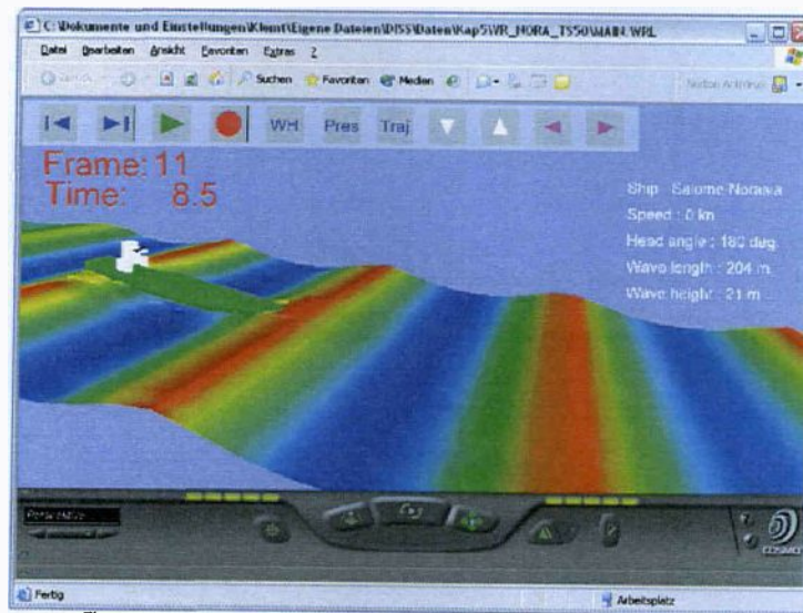
Abbildung 7.2 Anzeige der Auslenkung der freien Oberfläche für die Berechnung des Containerschiffes
