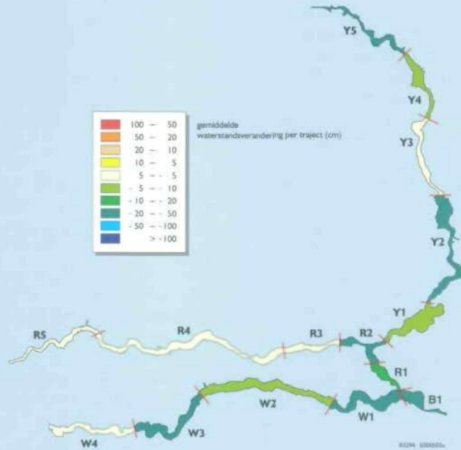
Waterstandsverandering door rivierverruiming bij stedelijke knelpunten langs de Rijntakken. De Rijnavvoer is 16.000 m 3 /s bij Lobith.
