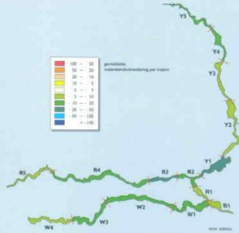
Waterstandsverandering bij verwijdering van obstakels in het rivierbed. De Rijnafvoer is 16.000 m 3 /s bij Lobith
