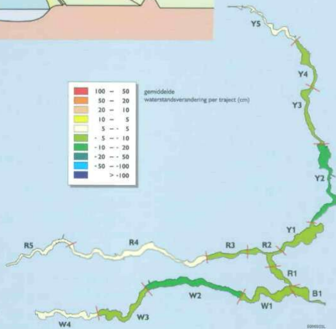
Waterstandsverandering, gemiddeld per RvR-traject, bij verlaging van de kribben. De Rijnafvoer is 16.000 m 3 /s bij Lobith.
