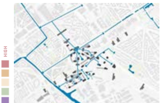
Met het irrigatienetwerk wordt regenwater gebufferd. The irrigation network buffers rainwater.
