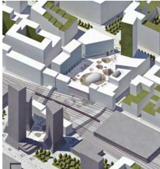
In de natte toestand is het verzonken plein een waterberging en kan het dienen voor koeling of verwarming. In de droge toestand is het plein een locatie voor evenementen. Under wet circumstances, the sunken square can partly fill up as a water storage, for cooling and heating. Under dry circumstances, the square is an event venue.
