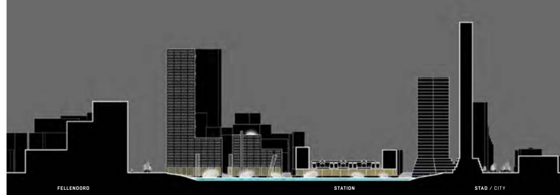
'Agora en suite': een opeenvolging van pleinruimten onder het spoor door. Het plein in natte toestand: waterbuffer voor warmte- en koudeopslag en wateroverloop. 'Agora en suite': a succession of square spaces tunnels the railway track. The square under wet conditions: water buffer for heat and cold storage and water surplus.
