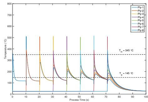
(d) Model v4 - 70 mm/s, 120 (°C) tool temperature & 2.1 mm heating length.
