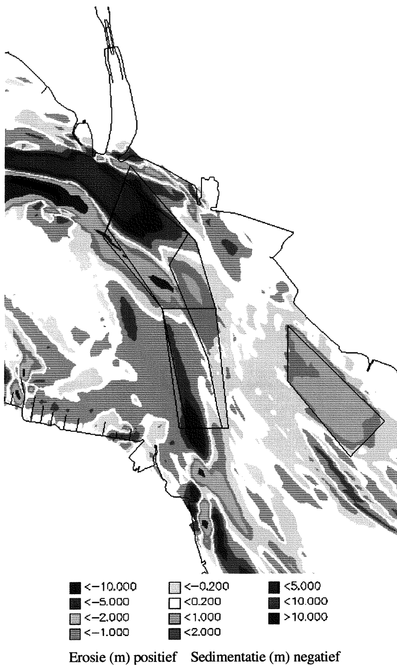
Figuur 4.9 Sedimentatie- en erosiepatronen na 1 jaar bodemontwikkeling; lokaties Vak 1, Vak 2, baggervak en Vak Schaar van Waarde (maandelijks baggeren en storten).
