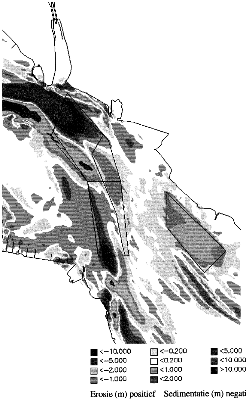
Figuur 4.12 Sedimentatie- en erosiepatronen na 1 jaar bodemontwikkeling; lokaties Vak 1, Vak 2, baggervak en Vak Schaar van Waarde (jaarlijks baggeren en storten).
