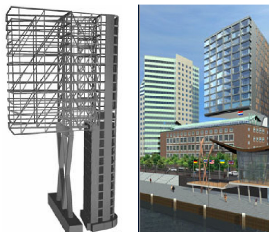
Figuur 80: draagconstructie HadM (Multi vastgoed)
