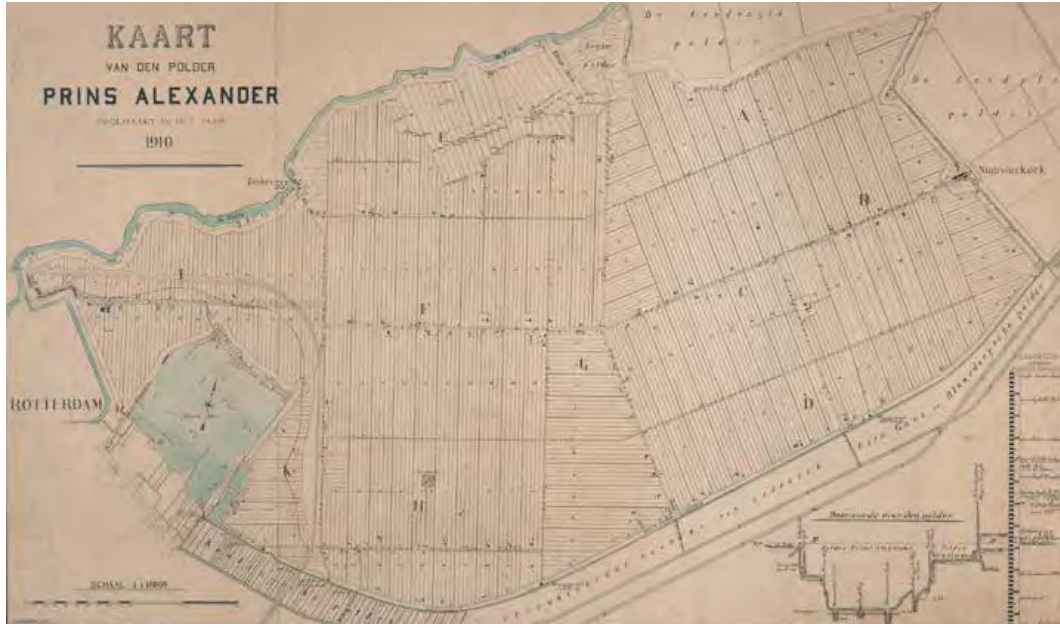
ILLUSTRATIE 6.41 Ontwerptekeningen Prins Alexanderpolder 1910.
