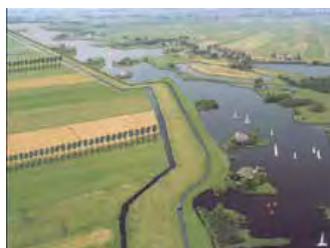
ILLUSTRATIE 8.5 De tussenboezem dient als berging waarin het waterpeil kan fluctueren. Collage bij hoge waterstand.
