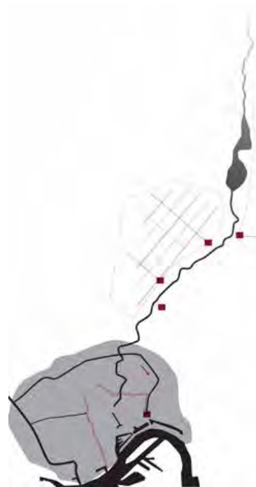
ILLUSTRATIE 6.57 Gereguleerde afwatering van plassen en polders via molens, boezem en uitwateringssluizen.
