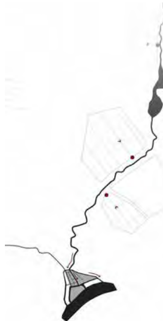
ILLUSTRATIE 6.54 Gereguleerde afwatering door inpoldering via molens, boezem en uitwateringssluizen.
