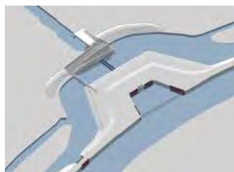
ILLUSTRATIE 8.19 Analysetekening van de context van het gemaal Onnerpolder. Het polderwater wordt geloosd op de Hunze.
