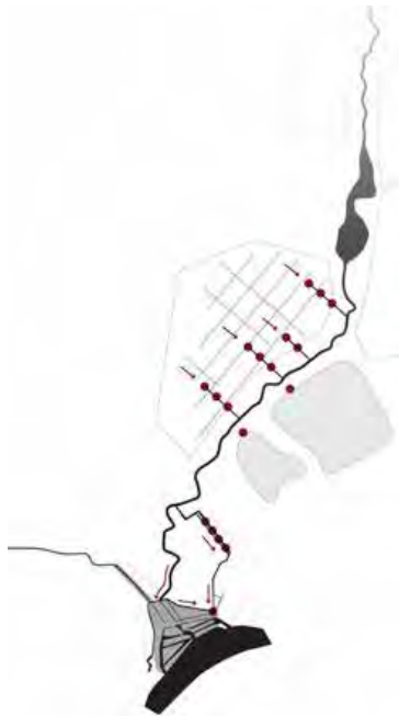
ILLUSTRATIE 6.56 Gereguleerde afwatering van polders via getrapte molengang via boezem, via parallelle molenrij, boezem en molen.
