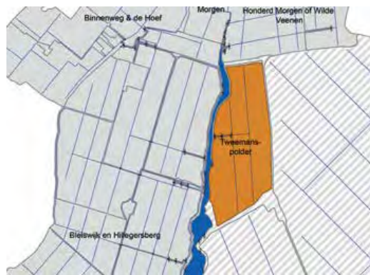
ILLUSTRATIE 6.29 Watersysteem Tweemanspolder rond 1900.
