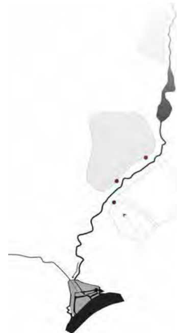
ILLUSTRATIE 6.55 Gereguleerde afwatering van plassen en polders via molens, boezem en uitwateringssluizen.
