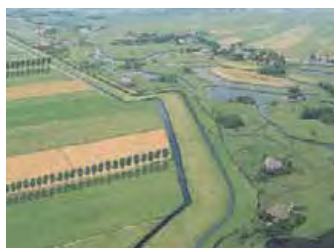
ILLUSTRATIE 8.4 De tussenboezem dient als berging waarin het waterpeil kan fluctueren. Collage bij lage waterstand.
