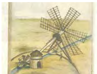
ILLUSTRATIE 3.23 Draaimolen (oude tekening): Een van de eerste ontwerpen voor een molen om water van het ene niveau naar het andere te hevelen. In eerste instantie werd met menskracht en later met de kracht van dieren, voornamelijk paarden gewerkt.
