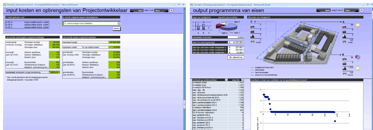
Figuur 16: input kosten en opbrengsten en rechts het outputvenster. In de grafiek en tabel is te zien welke variabelen een grote of kleine invloed hebben op de variabele die ze gemaximaliseerd hebben.
