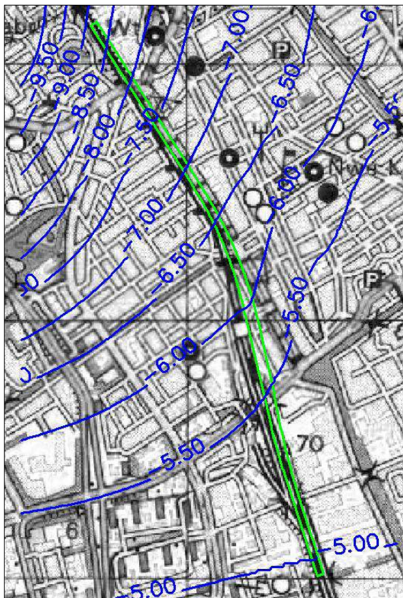
Fig. D.5.2 stijghoogte diepe tussenzandlaag
