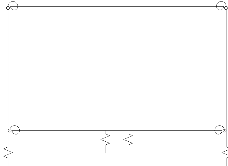
Fig. E.1.2.1 Schematisatie invoer raamwerkprogramma
