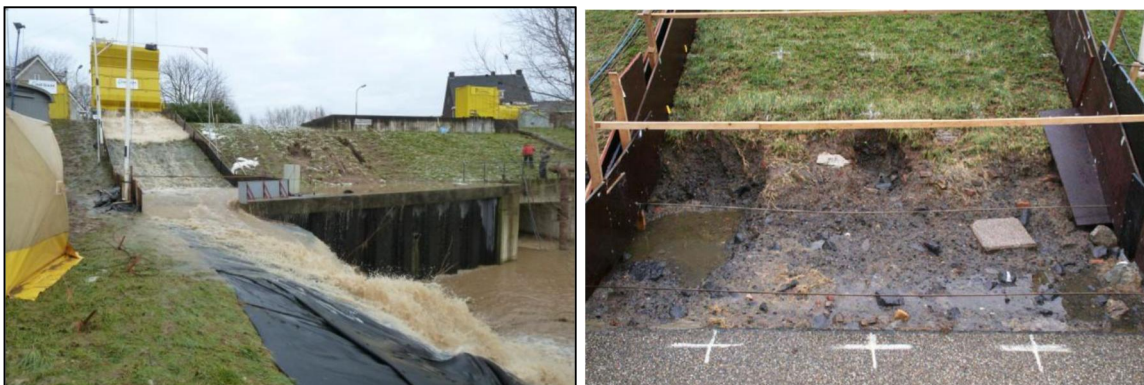
Figuur 4.3 Links: test met golfoverslagsimulator op de overgang van gras naar een betonnen muur (bron: Pijpers, 2013). Rechts: resultaat na een test op een overgang naar asfalt (Bron Rijkswaterstaat, 2012)
