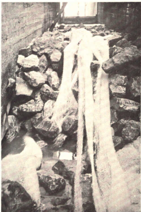
T5 schade na de maximale fase (gezien in benedenstroomse richting)
