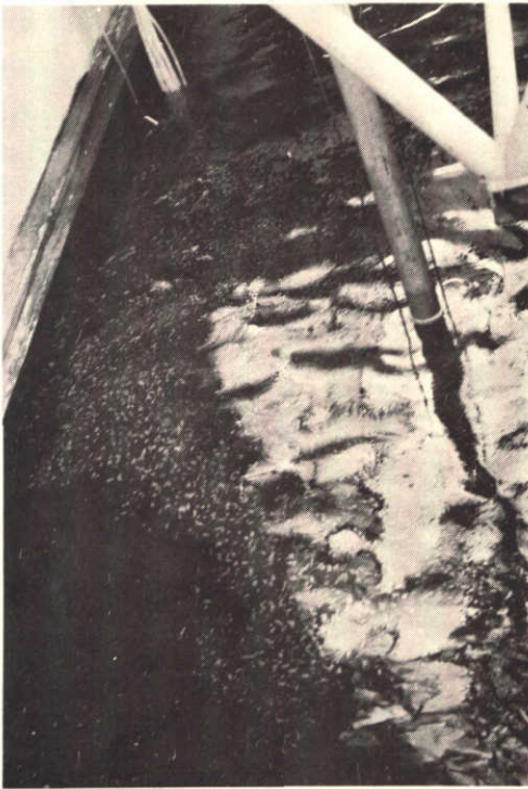
T7 uittreden van zand (schuimvorming)
