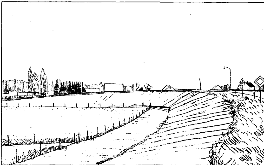
slecht vormgegeven oprit- met horizontale aansluiting- bij verzwaarde dijk bij Pannerden
