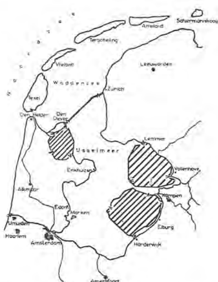
Fig. 36. Na het sluiten van de omringdijk van Oostelijk Flevoland op 13 september 1956 werd het oppervlak van het IJsselmeer opnieuw met 56.000 hectare gereduceerd.
