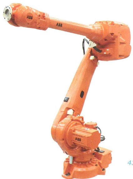
Figuur 5.1 – Industriële robot: Pick and Place robot van de firma ABB.
