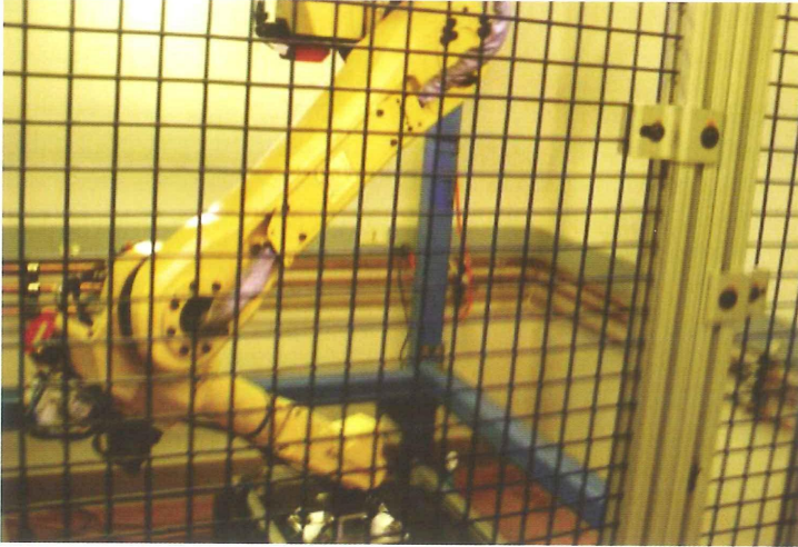
Figuur 5.2 – Industriële robot: Vanwege veiligheidseseisen achter hekwerk.
